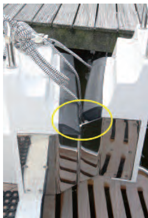
Im gelben Oval zu erkennen, der mächtige Querschnitt der umlaufenden Scheuerleiste, die Abfendern in vielen Fällen erübrigt.
