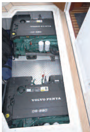
Die beiden kraftvollen Volvo-Penta D 6-330 Boliden beschleunigen diese NORTH-LINE 37 auf rund 46 km/h (25 kn).
